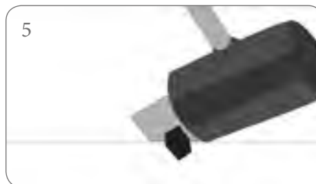
5 UNA VEZ SECADO EL CEMENTO COLA, GOLPEAR CON UNA MAZA DE GOMA LATERALMENTE PARA ROMPER EL CALZADOR. ONCE THE ADHESIVE HAS DRIED STRIKE WITH THE RUBBER Mallet TO BREAK THE COVER WEDGES. UNE FOIS LE CIMENT COLLE SÉCHÉ, TAPER AVEC UN MAILLET EN CAOUTCHOUC SUR LE CÔTÉ POUR CASSER LE CROISILLONS. SOBALD DER KLEBER GETROCKNET IST, WIRD SEITLICH MIT EINEM GUMMIHAMMER GEGEN DIE ZUGGLASCHEN GESCHLAGEN UM SIE AN DER SOLLBRUCHSTELLE RAUS ZU BRECHEN.
