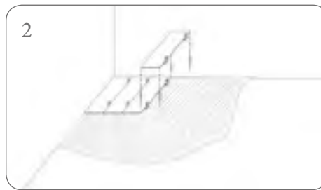
2 COLOCACIÓN PIEZAS CERÁMICAS CON LOS CALZADORES EN LAS JUNTAS. INSTALLATION OF THE PIECES WITH THE WEDGES AT THE EDGES. POSE DES PIÈCES AVEC LES CROISILLONS DANS LES JOINTS. VERLEGEN DER FLIESEN MIT ZUGGLASCHEN (VERLEGEHILFEN ZUM NIVELLIEREN).
