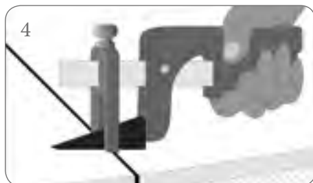
4 APRETAR CON EL ALICATE ESPECIAL. GRIP WITH THE CERAMIC PLIERS. PRESSER AVEC LA PINCE SPÉCIAL. NIVELLIERZANGE EINSETZEN.
